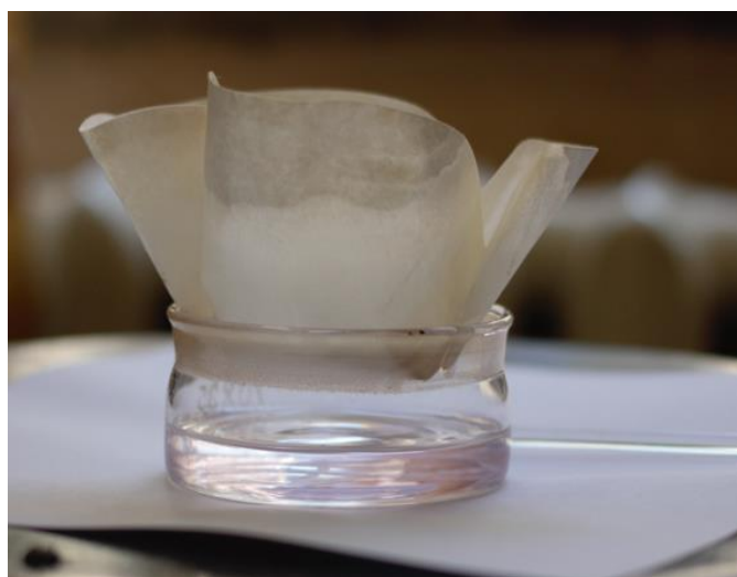
Рисунок 2.4. Зображення процесу відмивання осаду кристалів C_{60} від залишків парафіну н-пентаном
