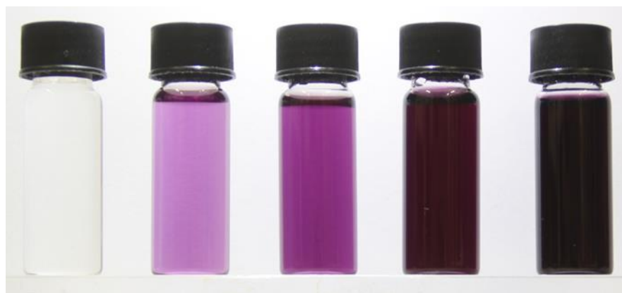
Рисунок 2.2. Фото зразків чистого тетраліну та тетраліну з вмістом фулерену C_{60} : 0,00050, 0,00100, 0,00299 та 0,00713 м.ч. (зліва направо, відповідно)
