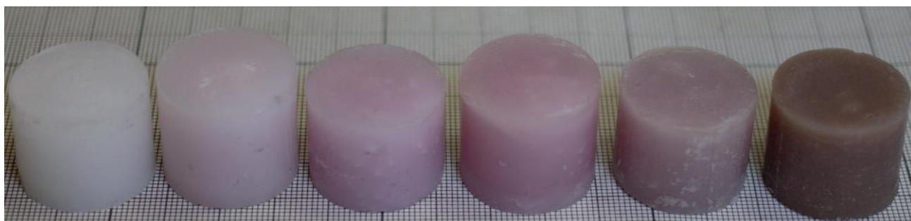
Рисунок 2.6. Зображення зразка чистого технічного парафіну (перший зразок зліва) та ТП/ C_{60} з різним вмістом C_{60} (зліва направо 0,00006, 0,00012, 0,00020, 0,00024 та 0,00052 м.ч.)
