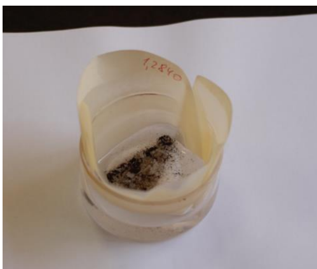
Рисунок 2.4. Зображення процесу відмивання осаду кристалів C_{60} від залишків парафіну н-пентаном
