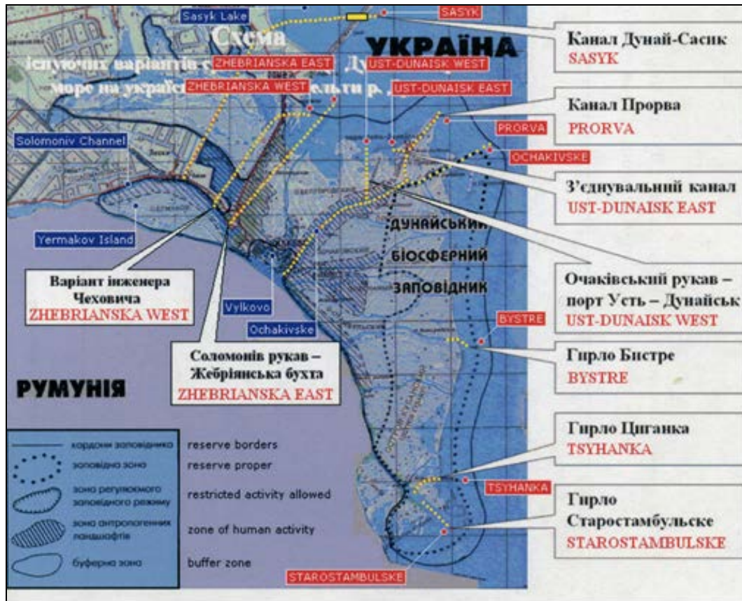
Рис. 3. Всі запропоновані варіанти траси суднового водного шляху у межах Кілійської частини дельти Дунаю (схема побудована Бездольним В.В. [1])
