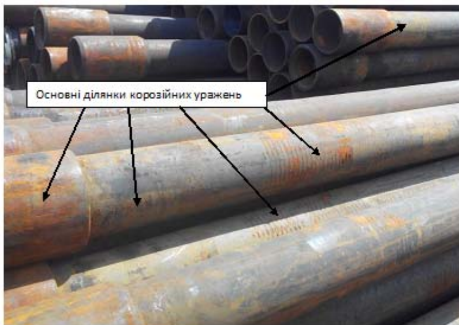
Рисунок 1 – Загальний вид НКТ з дефектами цинкового покриття
