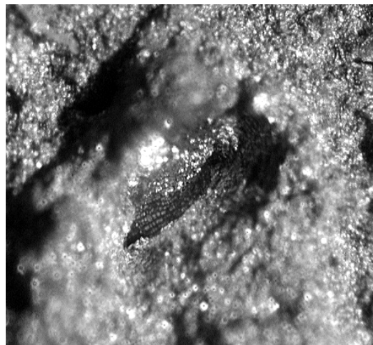
Рисунок 2. Структура газара (а) и вид поры в силумине АК8 со сферическими порами (б), x20
