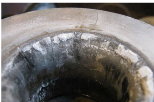
Рисунок 1 – Картина зносу матриці трубопрофільного пресу, [6]
