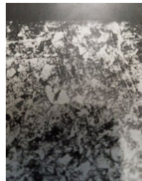
Рисунок 15 - Мікроструктура матричного кільця з сталі 5Х3В3МФС після загартування, відпуску і карбонітрації, ×600
