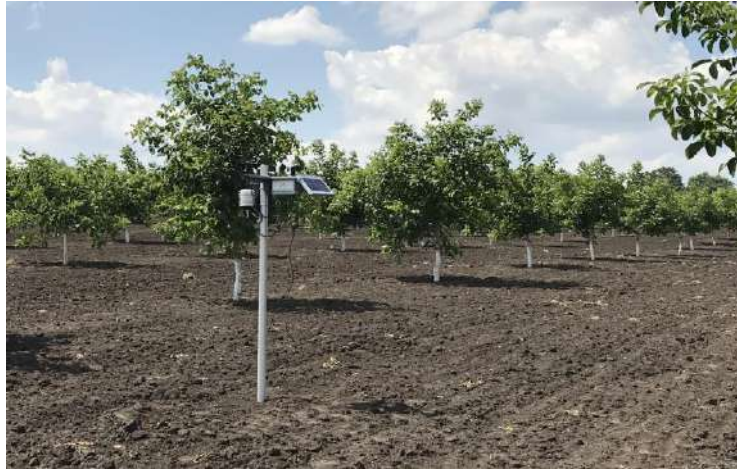
Рис. 1. Автоматична метеостанція МЕТЕОТРЕК RW 1.0 в одному із садівництв України. Фото МЕТЕОТРЕК. 2019 рік.
