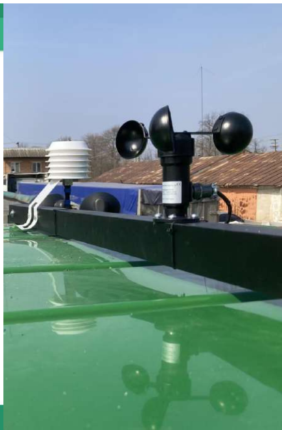
Рис. 3. Датчики швидкості вітру і фіксації температури та вологості повітря та атмосферного тиску, встановлені на обприскувач John Deere. Фото автора, 2021 рік.
