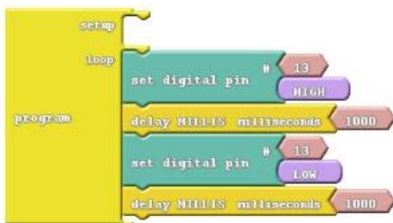
Рис.2 Програма для миготливого світлодіода в Ardublock
