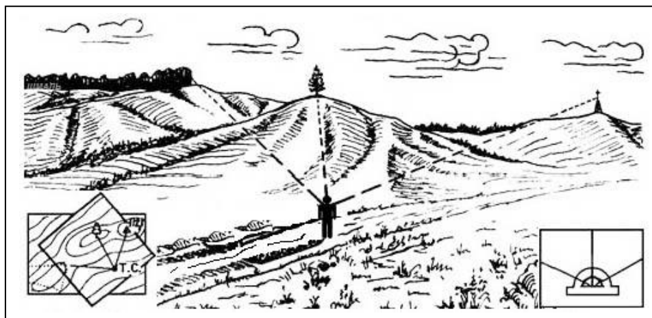
Рис. 26. Визначення точки стояння способом Болотова
