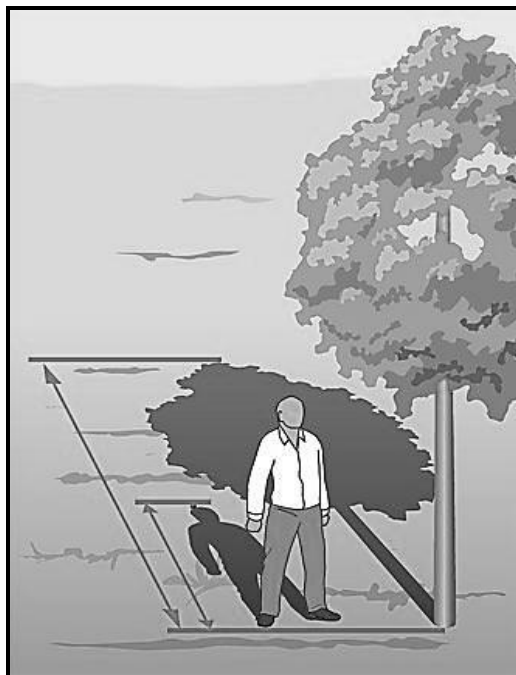
Рис. 33. Вимірювання висоти дерева за тінями
