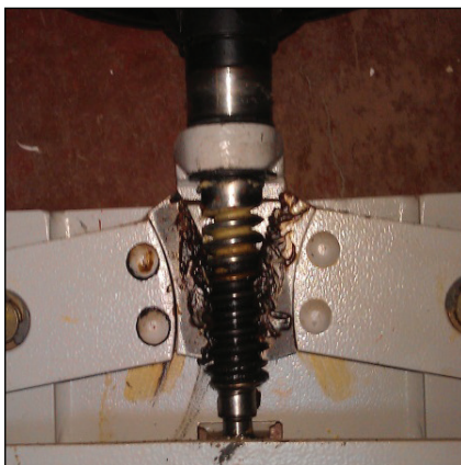
Рис. 1. Відновлення притискового механізму ріжучого апарату
